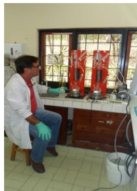
Digestión Cianuros-Equipo destilador CN
