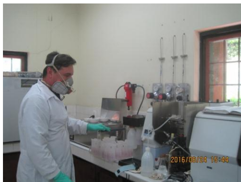
Lectura de Mercurio Equipo MHS-10 Generador De Hidruros
